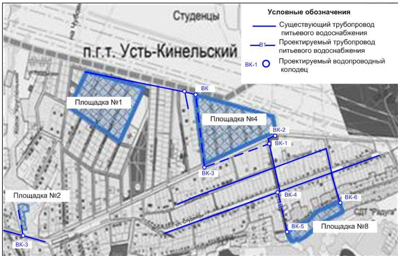
Рисунок 2.4.9.2 – Схема размещения планируемых объектов централизованной системы водоснабжения на территории п.г.т. Усть-Кинельский площадок №1, 2, 4, 8 перспективного строительства под жилую зону
